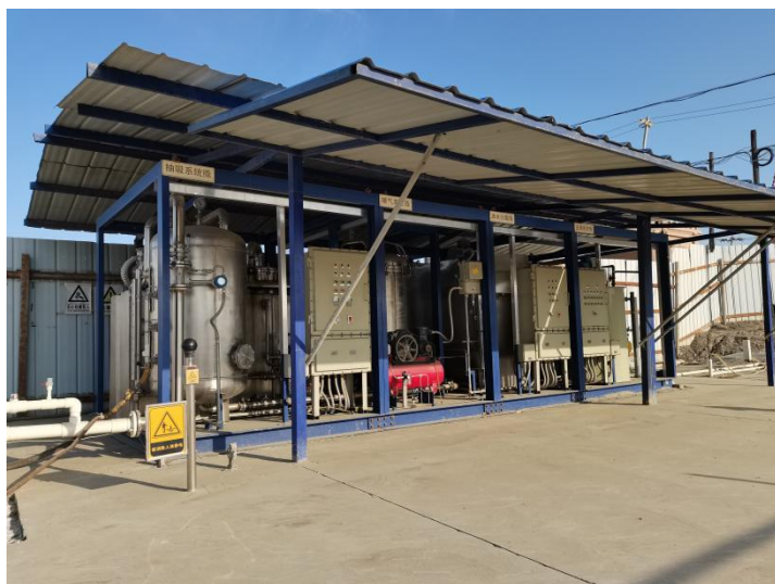
图 2 石油烃污染场地土壤地下水协同修复工艺链技术装置现场图
