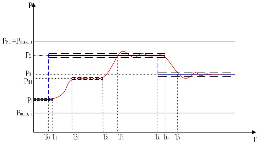
图中， $P_{\min,i}$  是该机组可调的下限出力， $P_{\max,i}$  是其可调的上限出力， $P_{Ni}$  是其额定出力， $P_{di}$  是其启停磨临界点功率。整个过程可以这样描述： $T_0$  时刻以前， $T_1$  时刻以前，该机组稳定运行在出力值  $P_1$  附近， $T_0$  时刻，AGC 控制程序对该机组下发功率为  $P_2$  的设点命令，机组开始涨出力，到  $T_1$  时刻可靠跨出  $P_1$  的调节死区，然后到  $T_2$  时刻进入启磨区间，一直到  $T_3$  时刻，启磨过程结束，机组继续涨出力，至  $T_4$  时刻第一次进入调节死区范围，然后在
